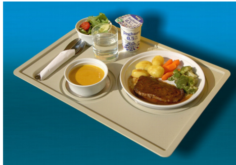
ThermoLine® ReTherm Heiztablett mit zwei temperaturgeregelten Kontaktwärmehitzonen für Suppe und Hauptspeise. Geeignet für Cook & Serve, Cook & Chill und Cook & Freeze.
